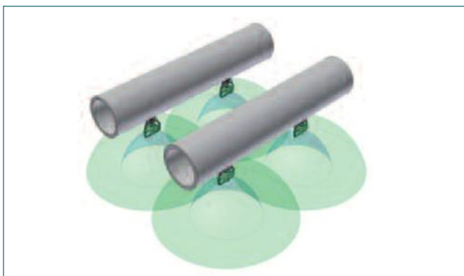
Figura 8. Distribuição dos bicos aspersores de água nos resfriadores SLI e SLMI e condensadores SLC e SLMC
