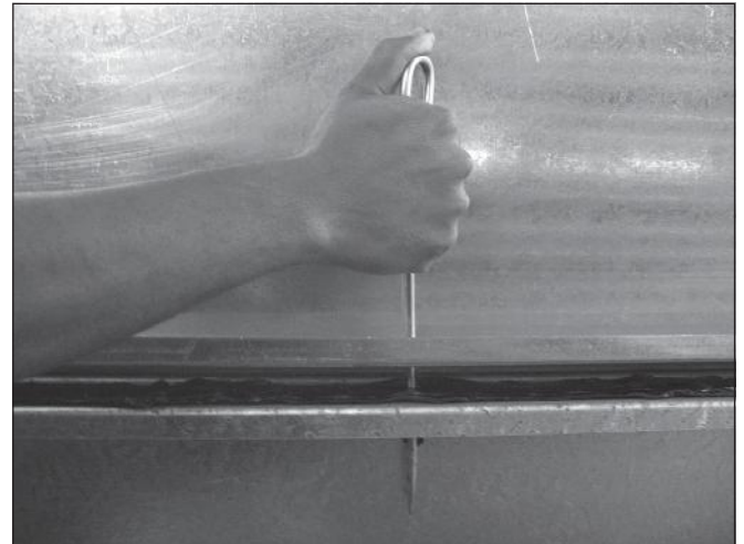
Figura 10. Introdução dos pinos-guia (alavanca tipo espina)
