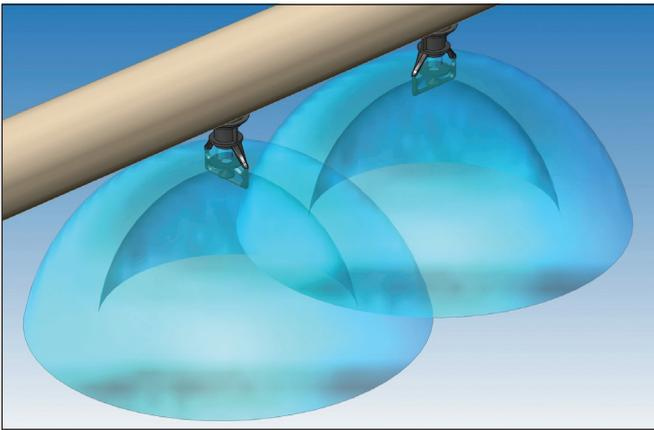
Figura 3.1. Distribución de toberas de aspersión de agua en los Condensadores SCD y Enfriadores SRI
